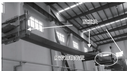
图7 疲劳加载试验现场
