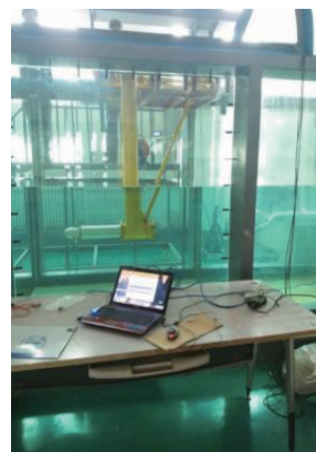
图 1 试验水槽及水轮机
