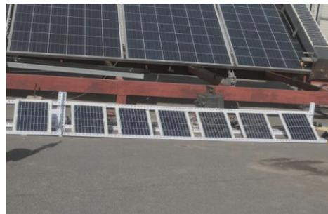
图 2 不同沙尘粒径的光伏组件
