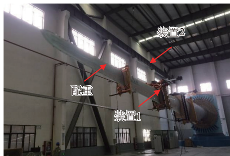
图6 叶片疲劳加载试验装置
