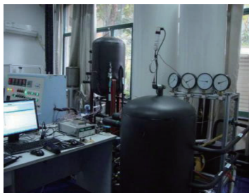
图3 新型太阳能热泵吸收子系统及调温水箱
