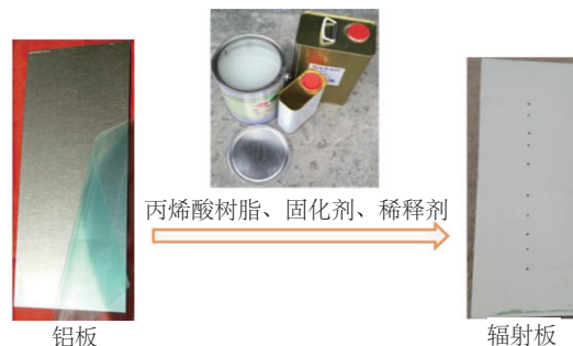
图3 辐射制冷铝板表面选择性吸收涂层结构图
