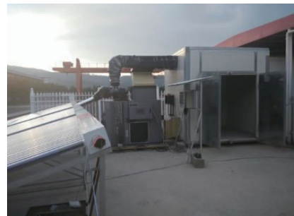
图8 太阳能-热泵干燥系统实物图
