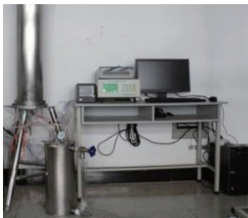
图3 两效竖管式太阳能海水淡化装置性能测试系统
