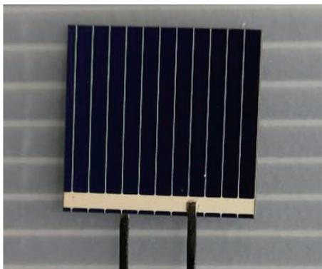
图2 晶体硅电池片
