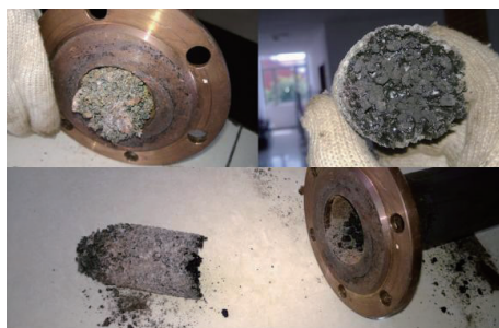
图 10 气化过程中的结渣现象
