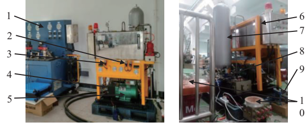
1. 液压站 2. 压力传感器 3. 流量传感器 4. 液压马达 5. 单相发电机 6. 油箱 7. 高压蓄能器 8. 电液比例阀 9. PLC 10. 负载
