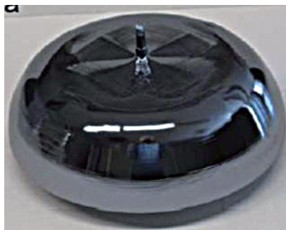
图2 无接触多晶硅坩埚法制备的大尺寸单晶硅
