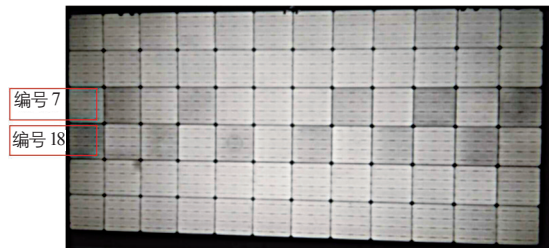
图3 组件EL测试图
