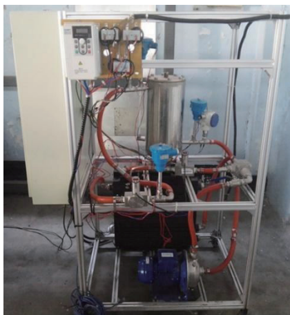
图6 水冷 PEMFC 热管理测试系统
