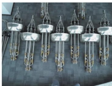
图 4 不同输水管径的试验模型
