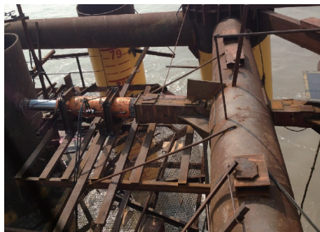
图4 水平力试验反力装置 Fig. 4 Anti force device for horizontal force test
