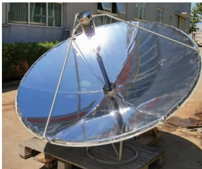
图3 碟式聚光器实物图 Fig. 3 Photo of dish concentrator
