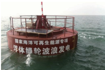
图2 海试中的浮体绳轮波能装置样机
