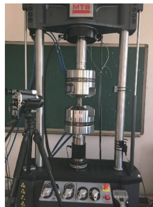
图 2 叶片加载试验系统图
