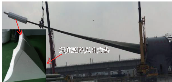
图3 基于降风阻力器的疲劳试验现场
