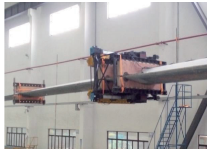
图8 疲劳加载试验装置
