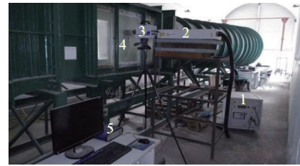
1. 激光器电源 2. 激光器 3. CCD相机 4. 测试窗口 5. 同步器
