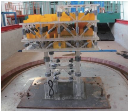
图 1 海上电气平台实验模型 Fig. 1 Test model of offshore substation platform
