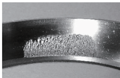
图14 轴承外圈故障图
