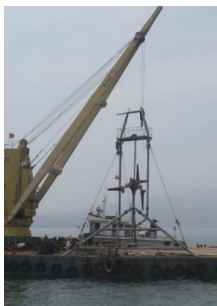
图 11 15 kW 自变距水平轴潮流能发电装置海上试验
