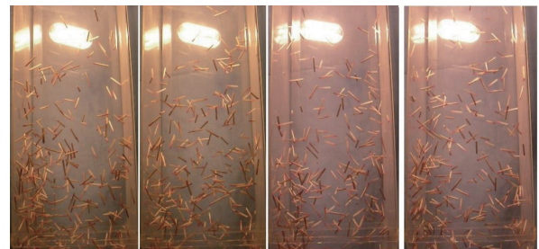
图2 提升管内不同时刻的细长颗粒流化运动照片(5 m/s)
