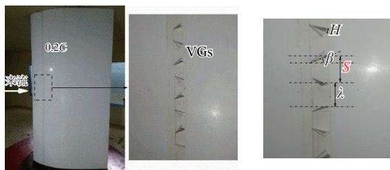
图7 实验翼型及VGs排列方式
