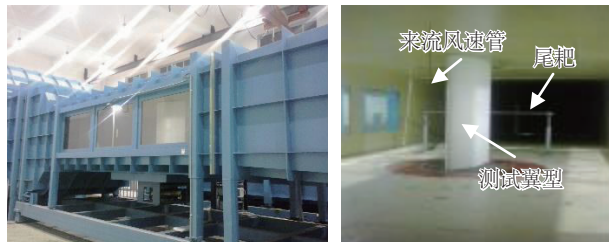
图1 风洞二元段及测试翼型
