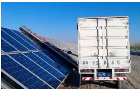
图4 应用于西部地区的车载清洁式机器人
