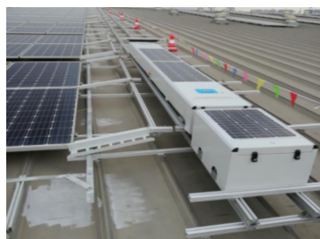
a. 应用于分布式光伏电站的摆渡车式清洁机器人
