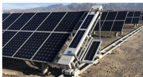
b. 应用于地面电站的摆渡车式清洁机器人
