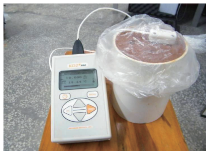
图1 土壤热导率测试过程
