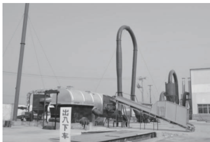
图6 农作物秸秆多级协同干燥系统
